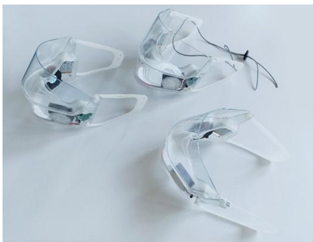
Maschera di protezione attiva Perfect Breath. Prototipo finale funzionante.
