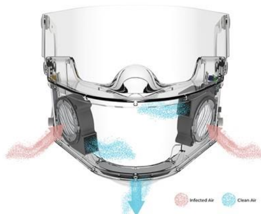
Schema dei flussi di aria filtrata in inspirato ed espirato
