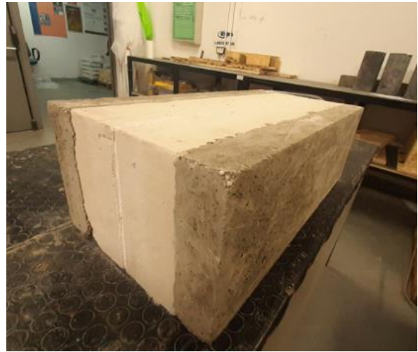
Blocco da costruzione sostenibile de isolante sviluppato per il progetto ICLIMABUILT.
