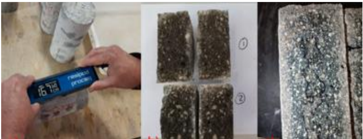
Testing su miscele AAM cement-free per la selezione del mix-design
