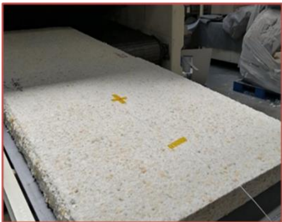
Preforma consolidata per thermo-bonding
