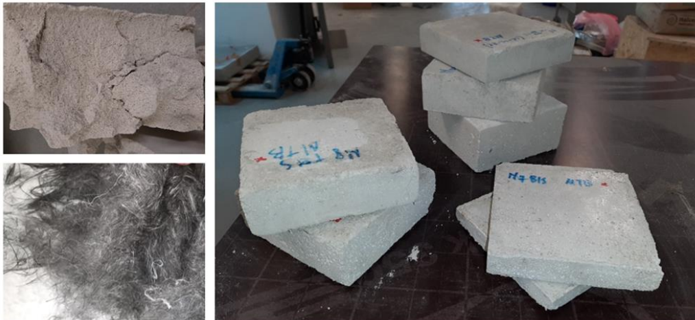
Materiali utilizzati e prototipo delle lastre leggere rinforzate con fibre di carbonio da riciclo
