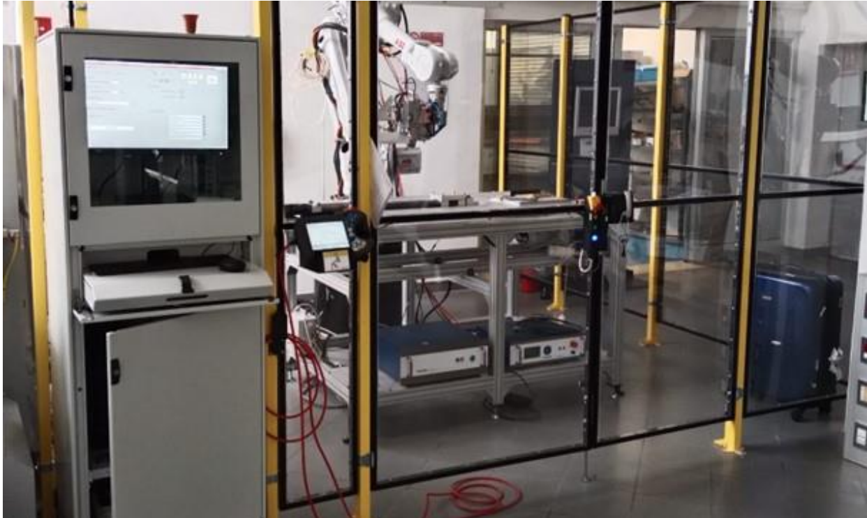
Attrezzatura IW installata sul braccio antropomorfo utilizzata durante i test di saldatura
