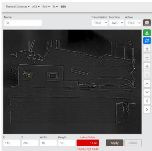
Interfaccia per il monitoraggio tramite IRT della temperatura ambiente e manufatti museali in legno
