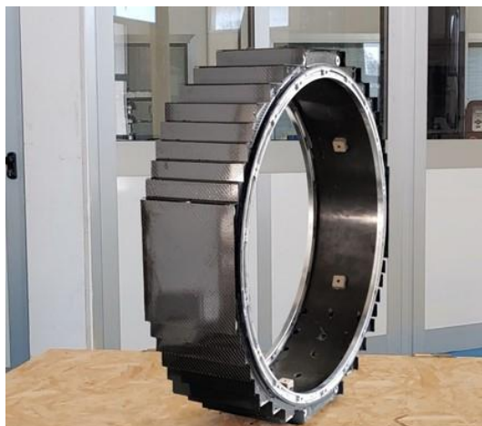
Assieme cilindro con scalettatura in prepreg carbonio (diametro interno 712 mm)
