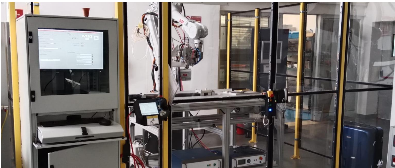
Cella di saldatura automatizzata
