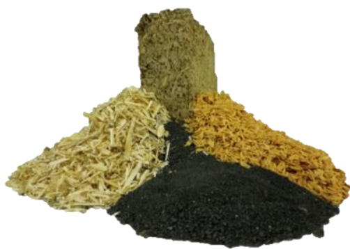
Materiali utilizzati per la realizzazione del blocco e prototipo del blocco a base di geopolimeri e scarti vegetali
