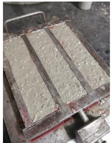
Granuli plastici da RAEE e miscela cementizia contenente tale plastica riciclata
