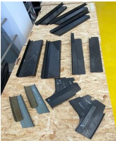
Prototipo dimostratori saldati nel progetto DEWTECOMP. I componenti saldati fanno parte del telaio di una porta di un aereo cargo, in rosso è evidenziata la loro posizione nell'assieme finale.
