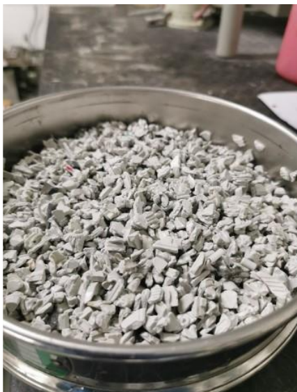
Granuli plastici da RAEE e miscela cementizia contenente tale plastica riciclata
