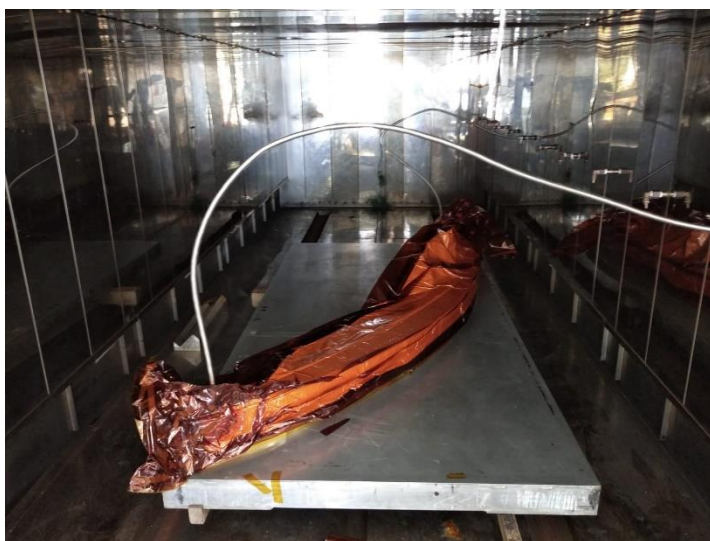
Posizionamento della preforma in forno per il riscaldamento, dopo la chiusura del sacco a vuoto
