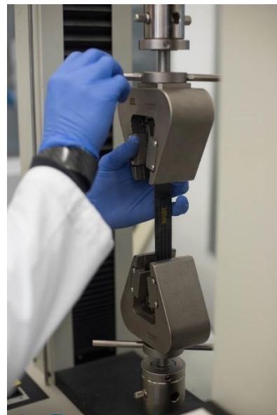
Esempio di test a trazione su un provino di prepreg in fibra carbonio
