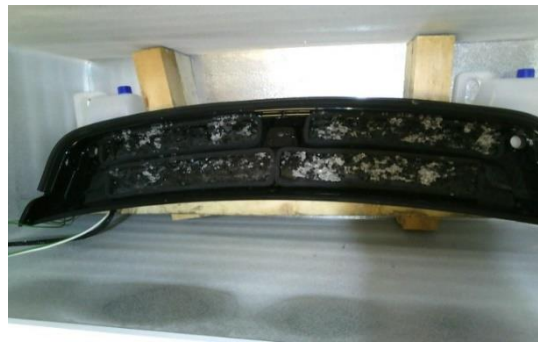
Componente griglia sottoparabrezza con funzionalità self-deicing. Dimostratore finale, realizzato in collaborazione col partner ALKE, e costituito da un componente termoformato in materiale standard (ABS) su cui sono integrate una serie di elementi piani riscaldanti in ABS caricato con CNT. In basso, test di deicing a bassa tensione applicata.
