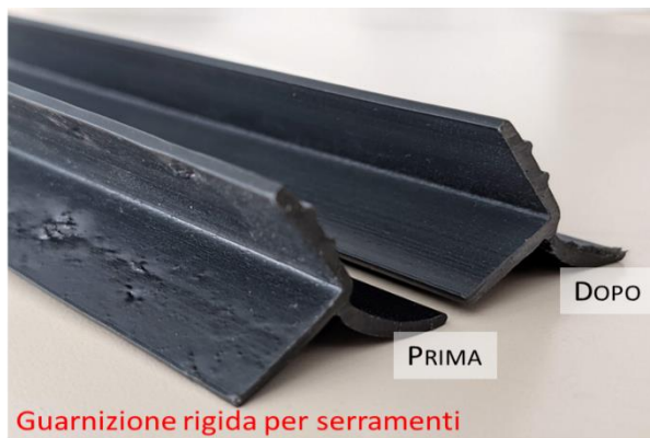
Alcuni dimostratori finali di progetto, confronto della qualità di prodotto prima e dopo l'ottimizzazione del processo di riciclo.
