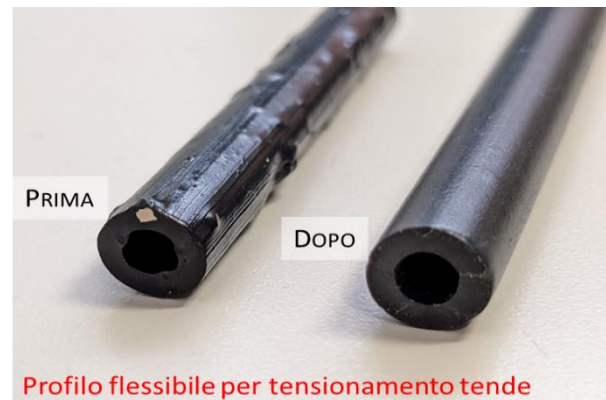
Alcuni dimostratori finali di progetto, confronto della qualità di prodotto prima e dopo l'ottimizzazione del processo di riciclo.
