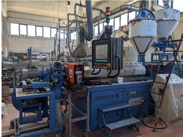
Produzione di compound da riciclo di PVC misto rigido e flessibile mediante estrusione.
