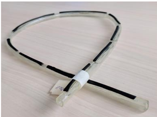
Componente griglia sottoparabrezza con funzionalità self-deicing. Dimostratore finale, realizzato in collaborazione col partner ALKE, e costituito da un componente termoformato in materiale standard (ABS) su cui sono integrate una serie di elementi piani riscaldanti in ABS caricato con CNT. In basso, test di deicing a bassa tensione applicata.
