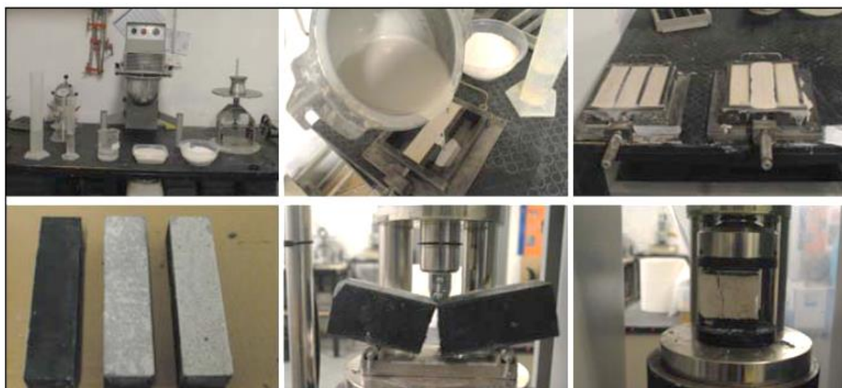
Produzione e realizzazione di legante per calcestruzzo innovativo "cement free"
