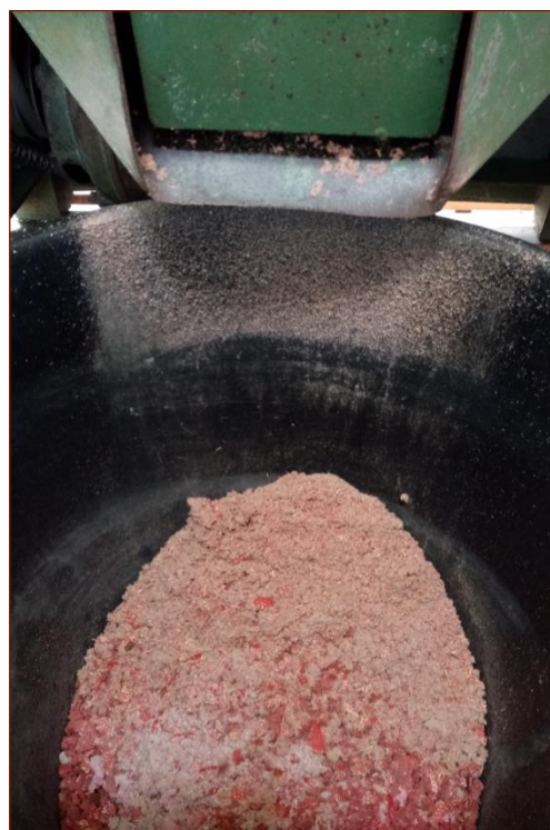
Scarto macinato utilizzato come carica nei pallet in plastica
