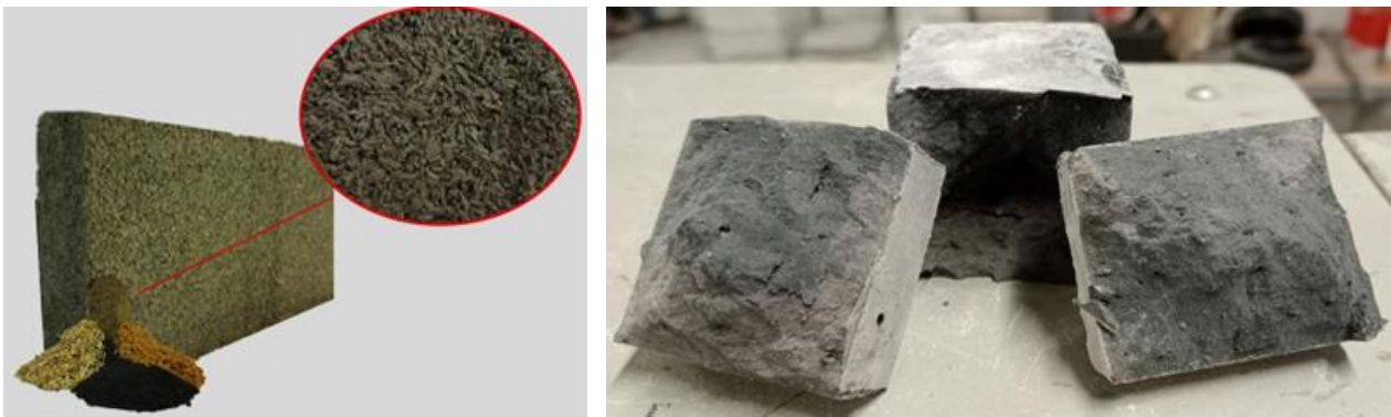
Legante geopolimerico allo stato indurito e prototipo del blocco "green" a base di geopolimeri e scarti vegetali
