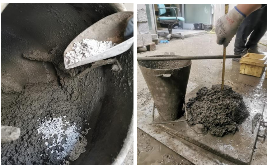
Produzione e validazione miscela cementizia contenente granuli plastici riciclati da RAEE
