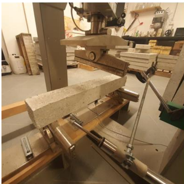
Test meccanici su componenti in calcestruzzo innovativo con fibre/aggregati riciclati
