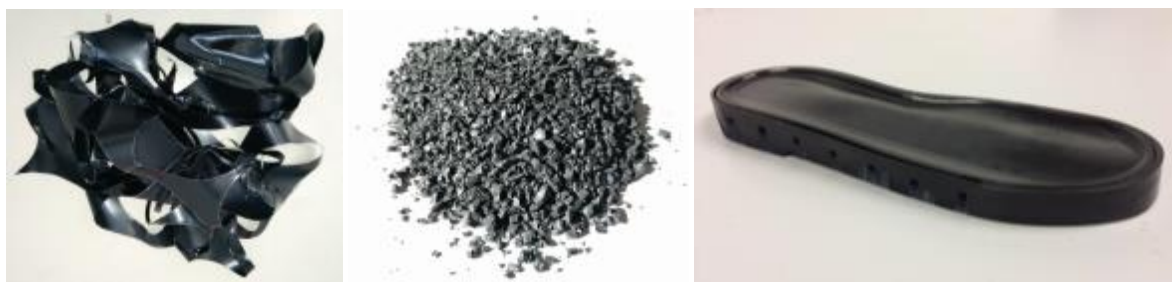
Scarti industriali di TPU calzaturiero prima (a sinistra) e dopo (al centro) il processo di ri-granulazione. A destra, suola in TPU 100% riciclato realizzata mediante stampaggio a iniezione.
