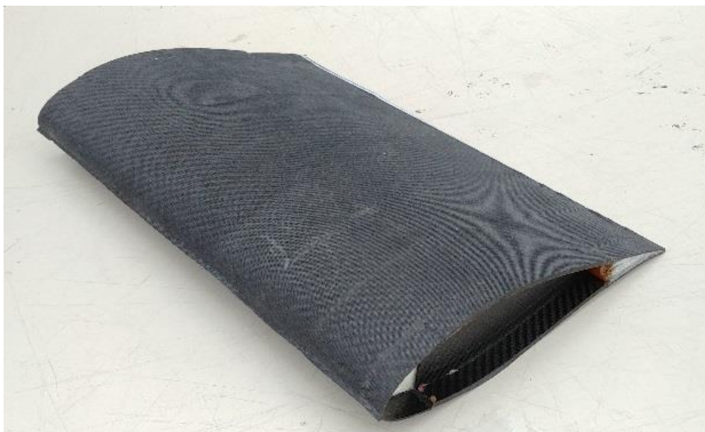
Winglet realizzato in infusione
