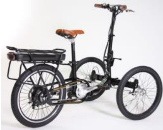
Etnic - Triciclo con doppia ruota anteriore elettrico e ripiegabile
