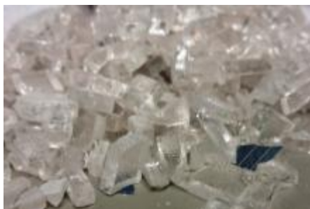
Vetro recuperato da pannelli fotovoltaici a fine vita e utilizzato in malte/calcestruzzi
