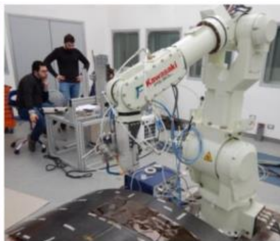
Attrezzatura per l'esecuzione della saldatura ad induzione
