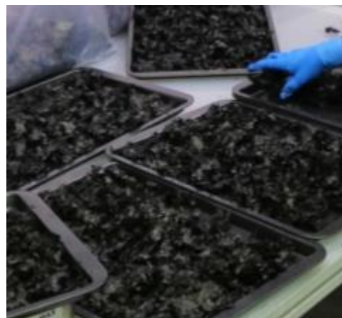
Fibre di carbonio da riciclo dopo il trattamento di sizing
