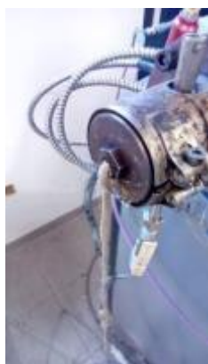
Miscelazione/Additivazione con estrusore bivate
