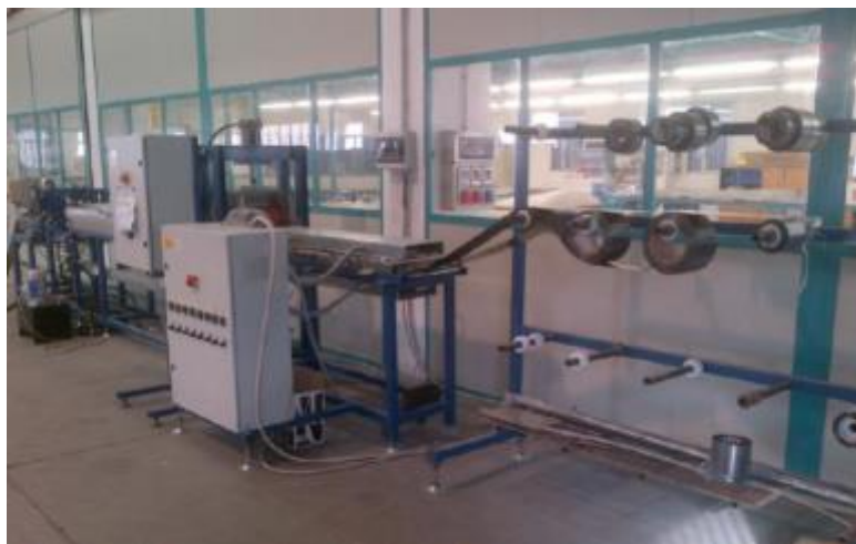
Attrezzatura per la produzione dei profili tramite stampaggio continuo
