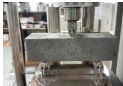
Test su malta con vetro riciclato per la valutazione della resistenza a flessione
