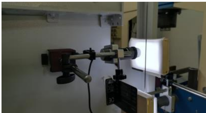
Microscopio nel vano lama della macchina
