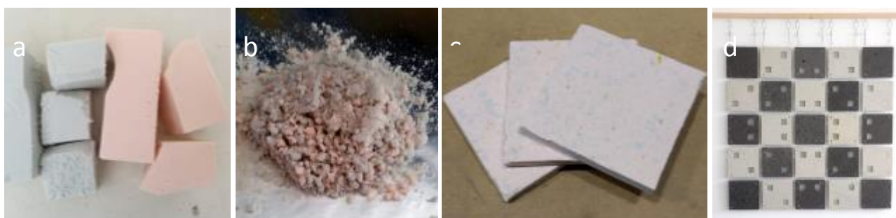
Scarti industriali di schiume rigide prima (a) e dopo (b) il processo di macinazione meccanica. Pannelli prodotti mediante processo di riciclo rebinding (c) e prototipo dimostratore di divisorio (d).
