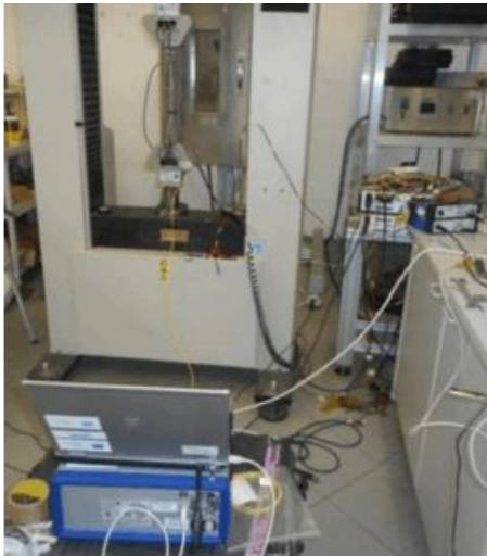
Set-up sperimentale per la validazione del sistema di monitoraggio strutturale e risposta nel tempo di un sensore a fibra ottica (FOS) confrontata con quella un estensimetro elettrico (SG)
