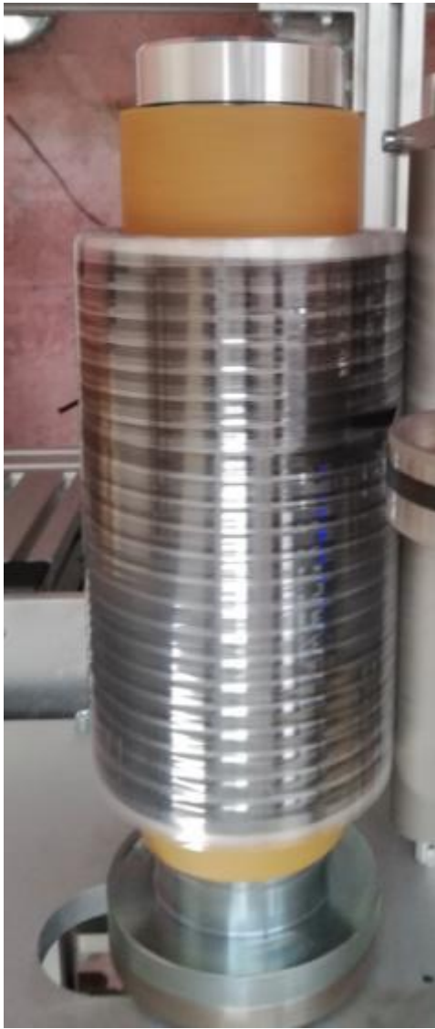
Tow-preg sviluppato nel progetto
