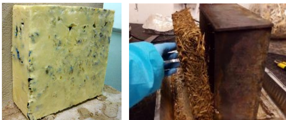
Sviluppo di materiali eco-sostenibili a base di CDW leggeri (plastica e legno, rispettivamente) per pannelli da costruzione.
