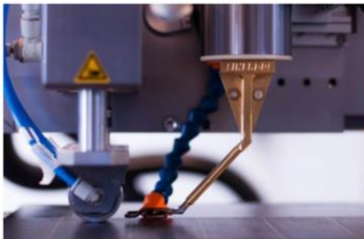
Attrezzatura per l'esecuzione della saldatura ad induzione
