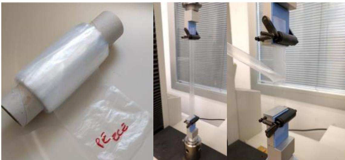
Figura 45: Campione di film estruso su cast (a sinistra) e successiva caratterizzazione meccanica: determinazione delle proprietà a trazione (al centro) e determinazione della resistenza alla delaminazione previo accoppiamento con un film di supporto (a destra).
