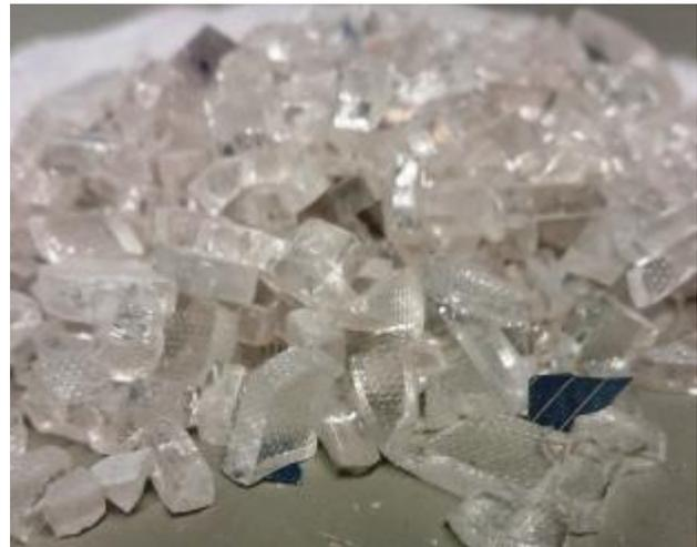
**Fig. 15** Vetro ottenuto da pannelli PV a fine vita e destinato allo sviluppo di materiali da costruzione sostenibili
