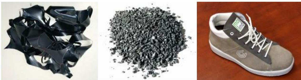
**Figura 29** – Scarti industriali di TPU calzaturiero prima (a sinistra) e dopo (al centro) il processo di ri-granulazione. A destra, il prototipo dimostratore di scarpa con suola in TPU 100% riciclato.
