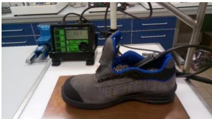
**Figura 27** – Prototipo di calzatura da lavoro con suola biodegradabile da fonti rinnovabili
