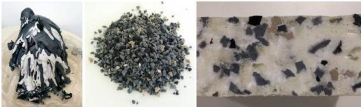
**Figura 31).** Come output delle attività relative al **riciclo di scarti di lavorazione della pietra naturale** sono state portate avanti la progettazione e realizzazione di un elemento di rivestimento per il settore costruzioni realizzato con agglomerati lapidei multifunzionali (smart stone) e di un prototipo di pannello sandwich sensorizzato.
