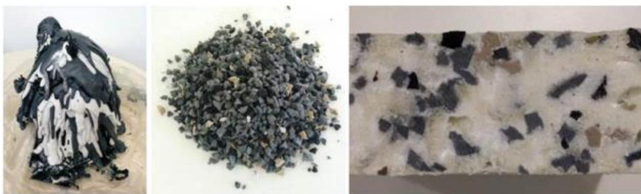
**Figura 31** – Scarti industriali di PU calzaturiero prima (a sinistra) e dopo (al centro) il processo di macinazione meccanica. A destra, sezione trasversale di un pannello prodotto mediante processo di riciclo *regrinding*.
