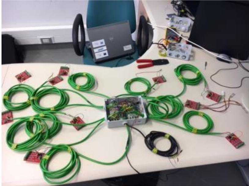
Figura 3 – sistema low cost per l’acquisizione dei dati a bordo macchina
