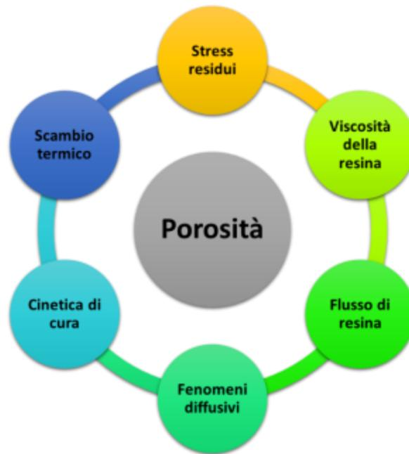
Figura 11 – Schema dei fenomeni fisici che controllano la formazione dei vuoti.
