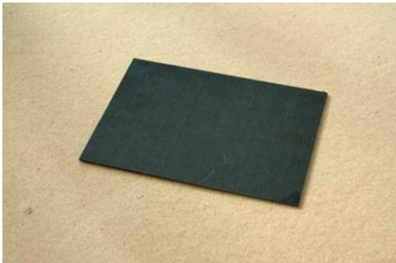
Figura 3-Laminato composito con RCF e matrice epossidica realizzato con il processo di infusione ottimizzato
