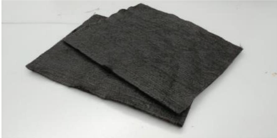
Figura 1- No-woven di fibre di carbonio da riciclo utilizzati per la messa a punto del processo di infusione
