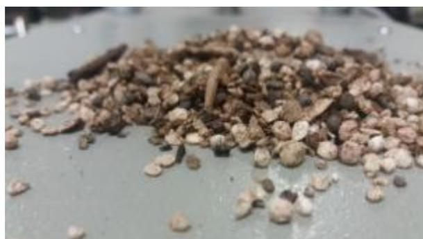
Fig. 11 Aggregato misto plastica/legno da CDW
