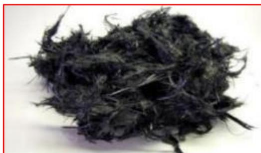
**Fig. 1:** Fibre di carbonio da riciclo corte
