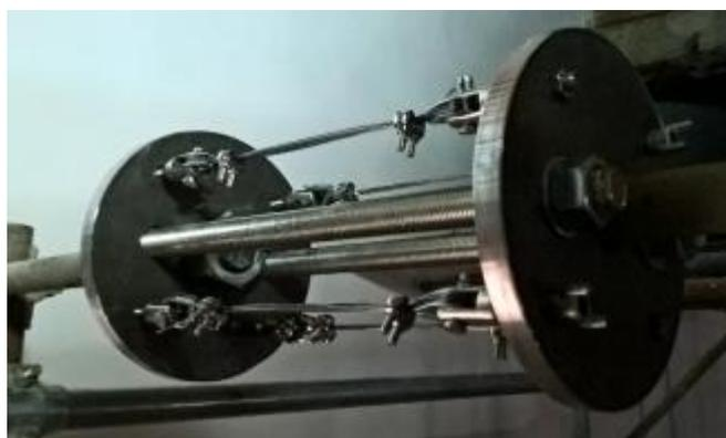
Figura 48 Dispositivo a base di SMA al termine del montaggio
