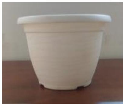
Figura 4: Dimostratore di vaso realizzato con un biopolimero bio-based e biodegradabile
