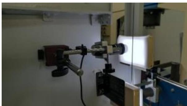
Figura 5 - Dispositivo di acquisizione immagini montato su macchina di taglio
