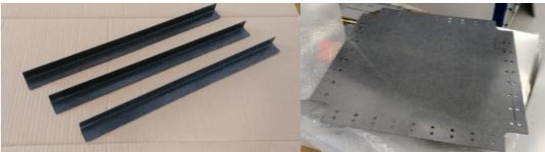
Figura 10 - Stringer e pannello rifilati per la saldatura
