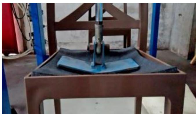
ARETA – Fondello rimovibile in EPP – Test di carico
