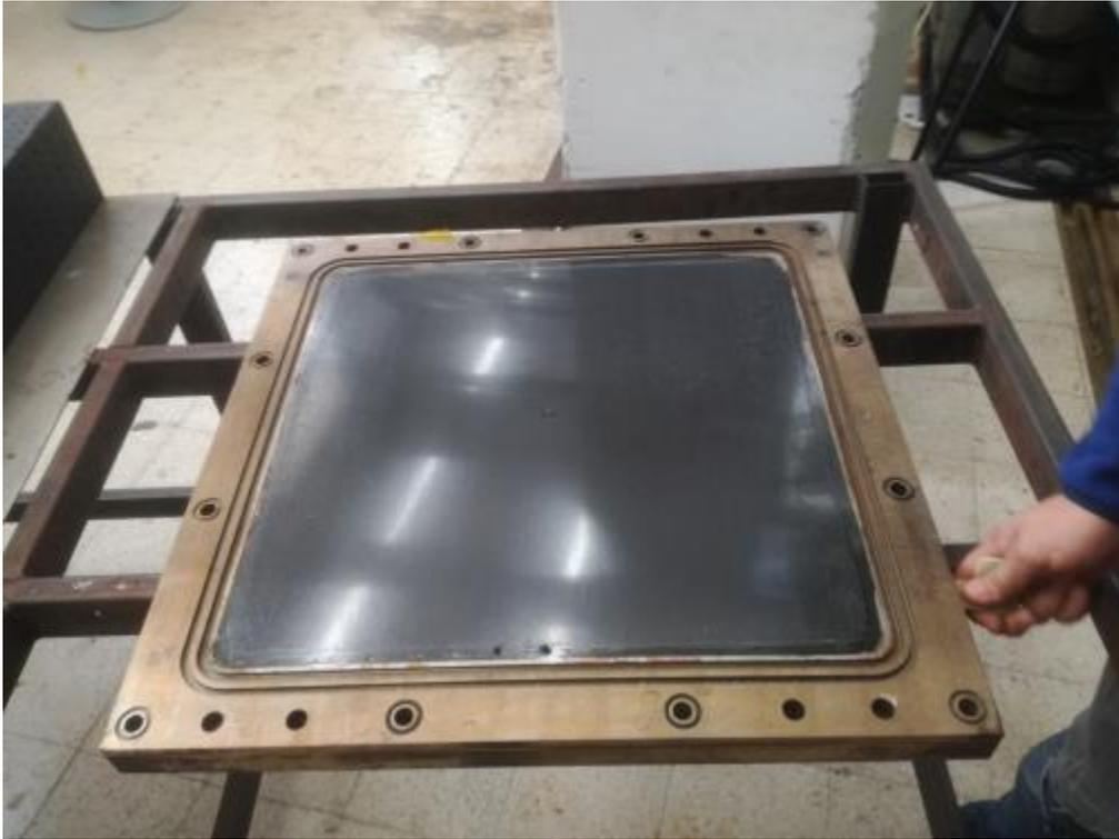
Figura 18-Apertura dello stampo dopo il ciclo di cura
