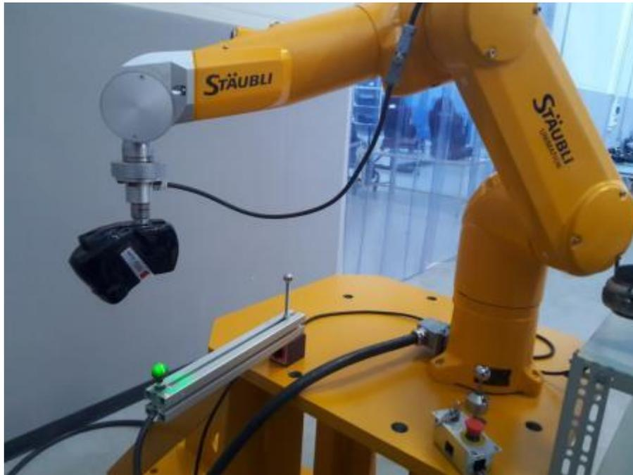
Foto del sistema di misura automatizzato dei difetti di strutture aeronautiche complesse
