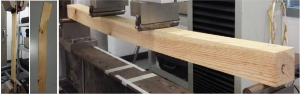
ALFORLAB -Prova di Flessione su 4 punti (immagine destra) , Prova di trazione (immagine sinistra)
