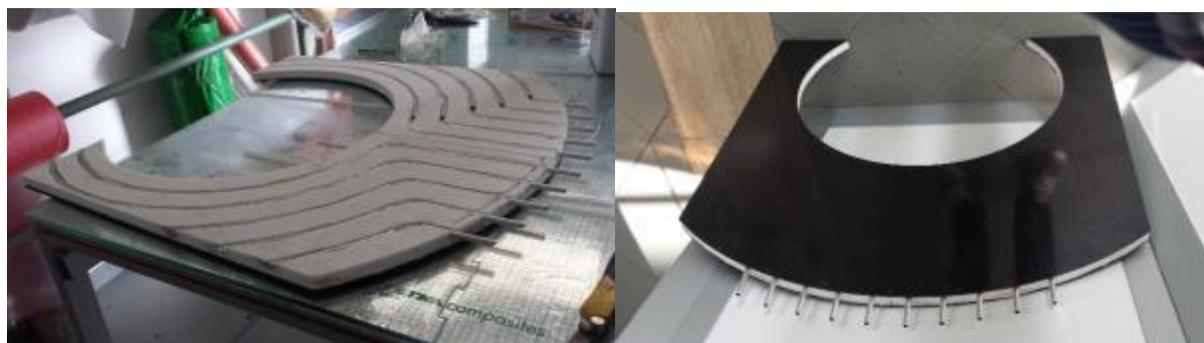
**INFN – Il pannello sandwich in complemento è riportato nella foto a sinistra, prima dell'applicazione della pelle esterna. Il prototipo completo è visibile nella foto di destra.**
