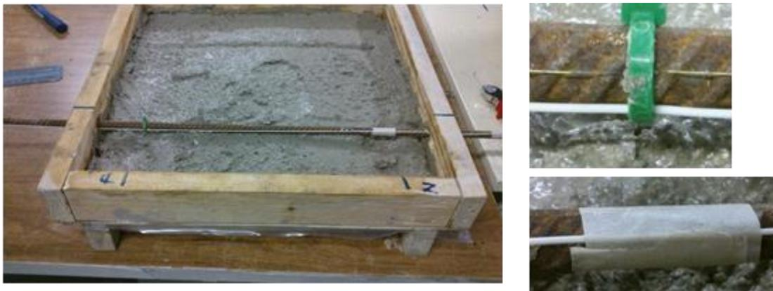
**MAIND- Prove di inglobamento di sensori in fibra ottica in elementi di calcestruzzo- configurazione 1**
