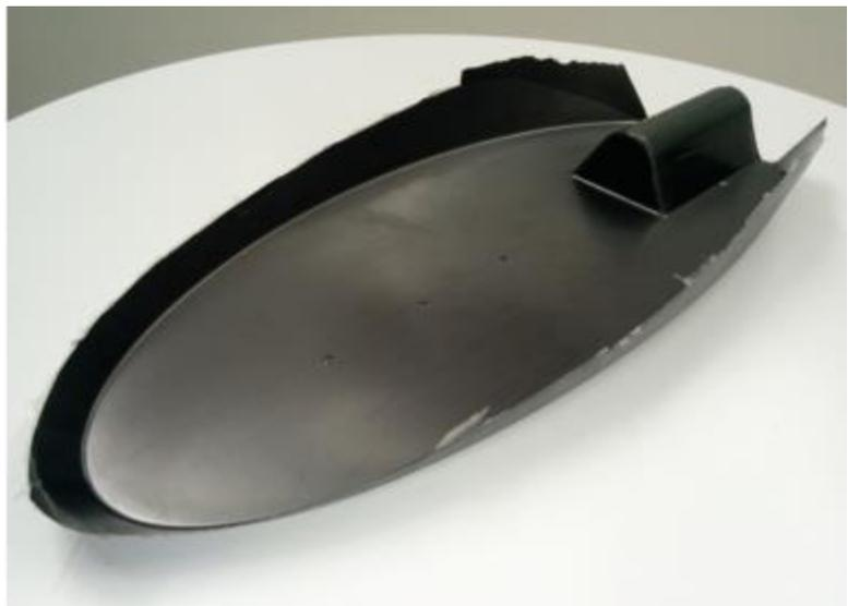
**NITEKO - Prototipo funzionale del dissipatore in carbonio.**
