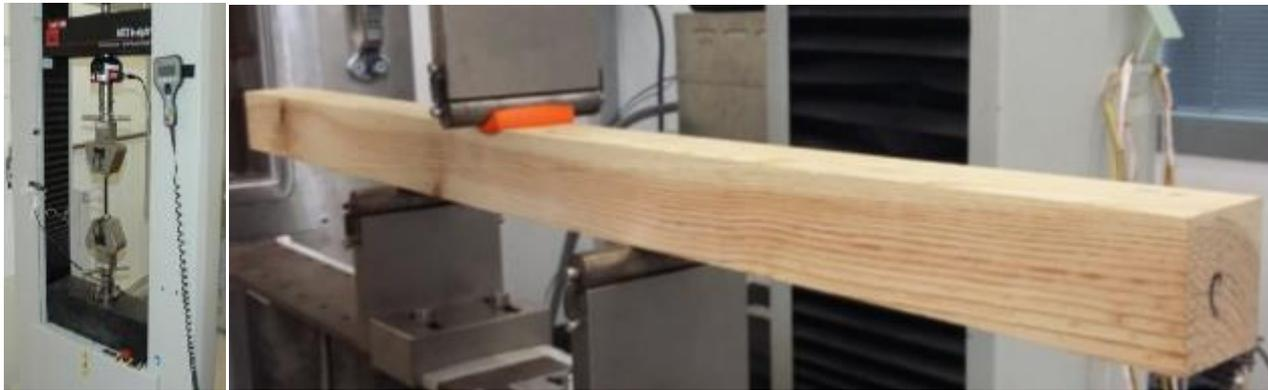
ALFORLAB -Dinamometro da 100 KN impiegato per i test sperimentali (immagine a sinistra)
