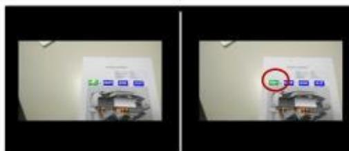
Il puntatore luminoso costituisce il «puntatore» (nel cerchio rosso) guidato dall'orientamento della testa. Una volta posizionato su una voce della GUI (Graphic User Interface), questa cambia colore, ed attiva la funzionalità richiesta (ad esempio il passaggio allo step successivo)
