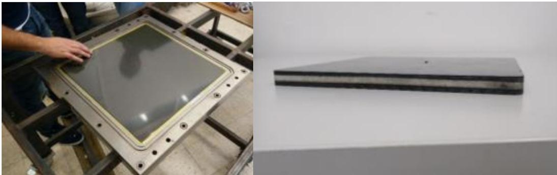
**SPIA - Test di iniezione di un pannello sandwich in schiuma Rohacell IG71 (PMI)**
