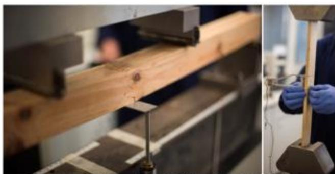
Strumenti di misurazione impiegati (LVDT a sinistra e ESTENSOMETRO a destra)
