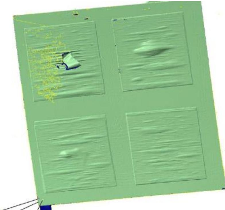
**MAIPCO - Valutazione delle difettosità tipiche del processo di deposizione automatizzata delle fibre con profilometro laser.**
