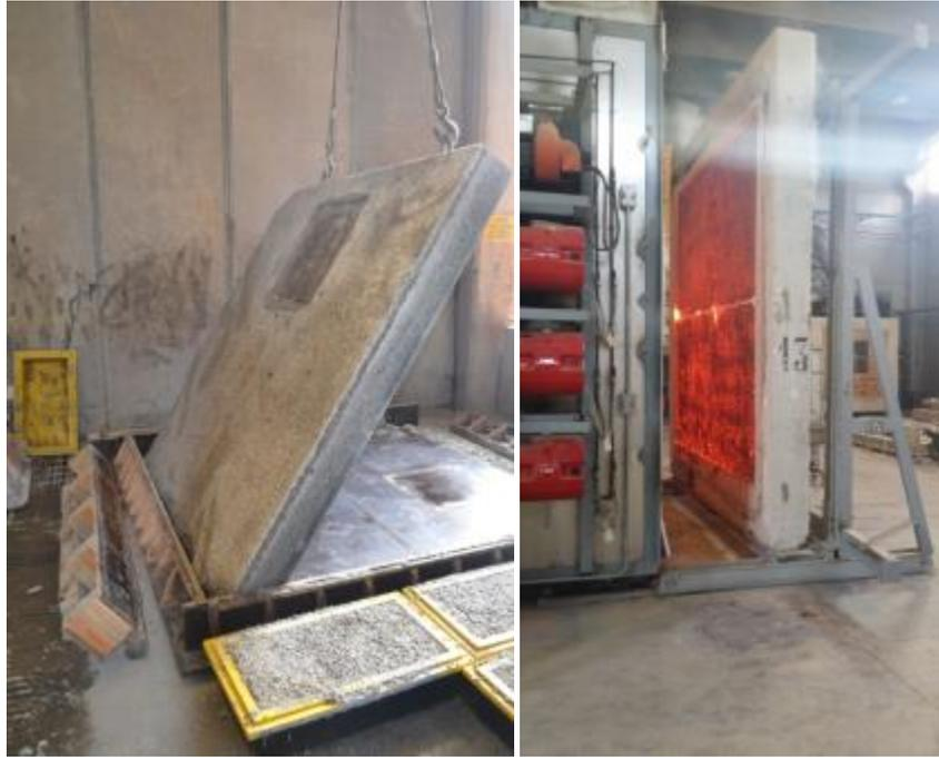
SUSCON - Produzione (sin) e prove di resistenza al fuoco (dx) su pannelli SUS-CON
