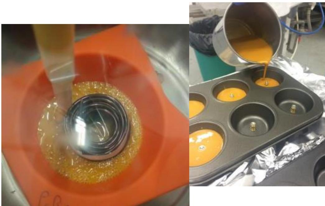
**SEB – A sinistra colata sotto vuoto di una resina epossidica in uno stampo siliconico contenente una bobina in rame. Il processo si completa con l'applicazione di una pressione che favorisce il riempimento delle cavità tra le spire. Sulla destra colata in aria di coupon di inserti incapsulati per i test meccanici.**
