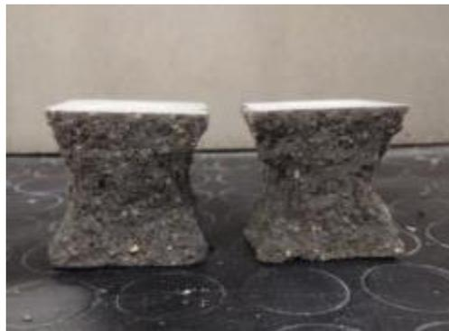
**EFFEDIL – Provini di malta geopolimerica a base di fly ash riciclate, dopo prova di compressione**
