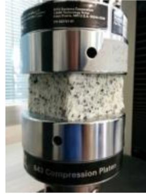
MAIND: Schiuma con il 50% di scarti macinati (sx) e test di compressione su un campione della schiuma stessa (dx).
