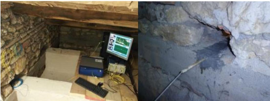
PROVACI - Sistema di monitoraggio installato presso il Convento di Sant'Angelo d'Ocre (sin) e dettaglio di smart rebar (barra pultrusa con inglobato sensore a fibra ottica – dx)
