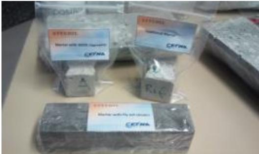
**EFFEDIL – Campioni di malta geopolimerica e di malta con aggregati alleggeriti da riciclo ad elevata prestazione termica**
