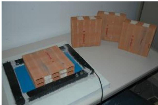
EFFEDIL – Set-up termografico su laterizi con PCM
