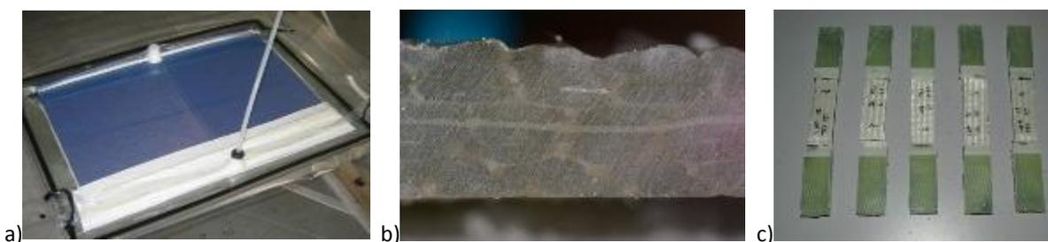
13-177 a) infusione di due pannelli – b) micrografia di un pannello infuso (sono evidenti le fibre di vetro e l'assenza di vuoti interlaminari) – c) provini sottoposti a test di trazione
