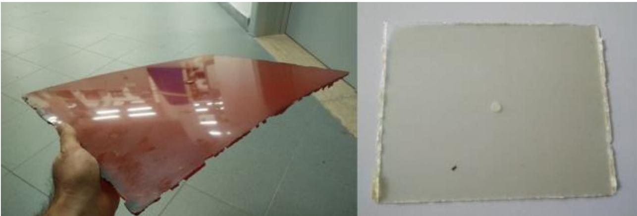
SEB - A sinistra un pannello Benzoxazine - Vetro e sulla destra un pannello Resina Epossidica – Vetro. Entrambi i pannelli sono stati realizzati con tecnologia RTM e fibre di vetro Binderizzate.
