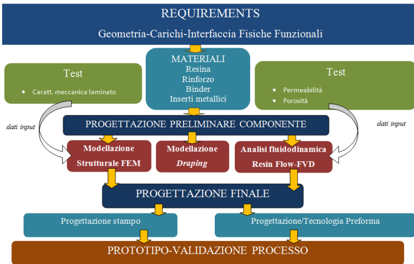
Schema della metodologia sviluppata da CETMA per la progettazione di componenti strutturali in RTM in ambito elicotteristico
