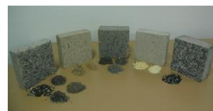
Campioni di calcestruzzo leggero eco-compatibile confezionato con aggregate da riciclo e legante naturale (cemento Portland)
