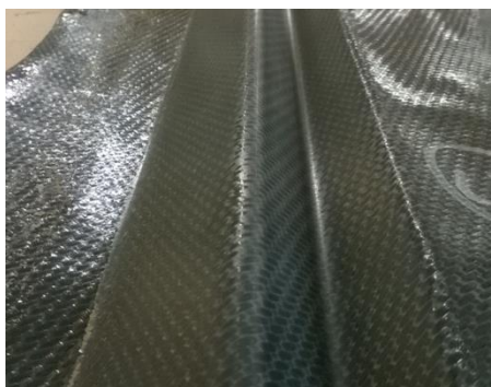
Vista di uno degli stringer prima della rifila
