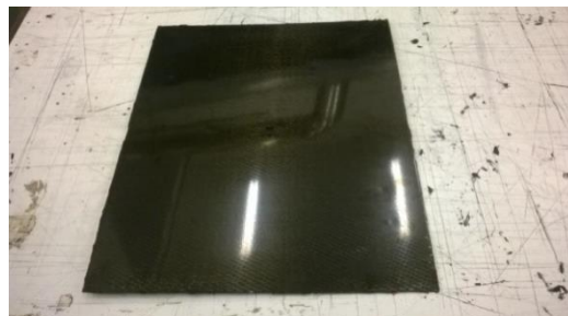
Laminato in fibra di carbonio e resina benzoxazina realizzato presso il CETMA
