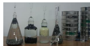
Caratterizzazione di aggregati leggeri da riciclo per calcestruzzi (da destra verso sinistra RAEE, gomme da pneumatici fuori uso, poliuretano, plastica da RSU)
