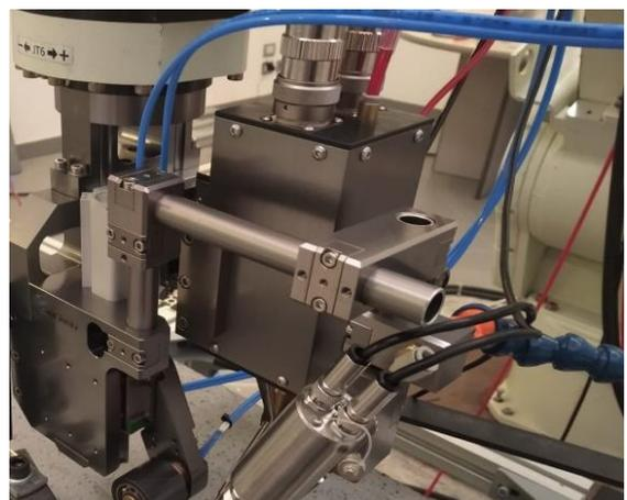
Testa di saldatura con termocamera
