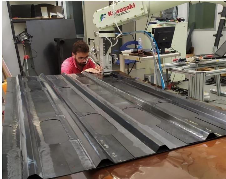
Assemblaggio dei componenti skin e stringer del prototipo mediante Induction
