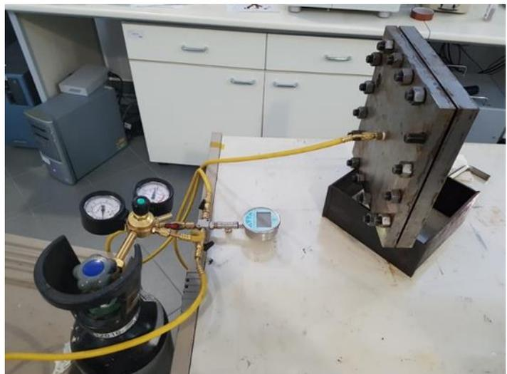
Tool progettato da CETMA per la misura della permeabilità ad un gas
