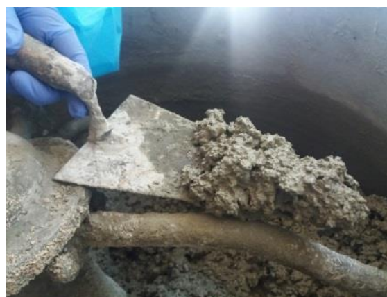
RESIELP: Calcestruzzo contenente vetro recuperato da pannelli fotovoltaici
