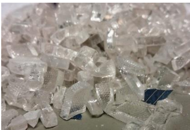
RESIELP: Vetro recuperato da pannelli fotovoltaici a fine vita e utilizzato per calcestruzzi e malte
