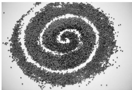
REVALUE: Compound prodotto nell'ambito del progetto REVALUE a partire dalle fibre di carbonio riciclate trattate chimicamente
