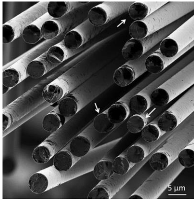
REVALUE: Immagine delle fibre di carbonio da riciclo derivanti da pirolisi ottenuta mediante microscopio a scansione elettronico (SEM)
