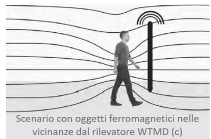
ITEL FMDS: Principio di funzionamento dei rilevatori FMDS (o anche WTMD – Walk-Through Metal Detectors)
