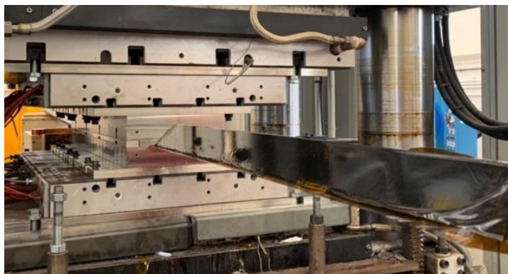
KEELBEMAN: Particolare del processo CCM per la realizzazione degli stringer 1
