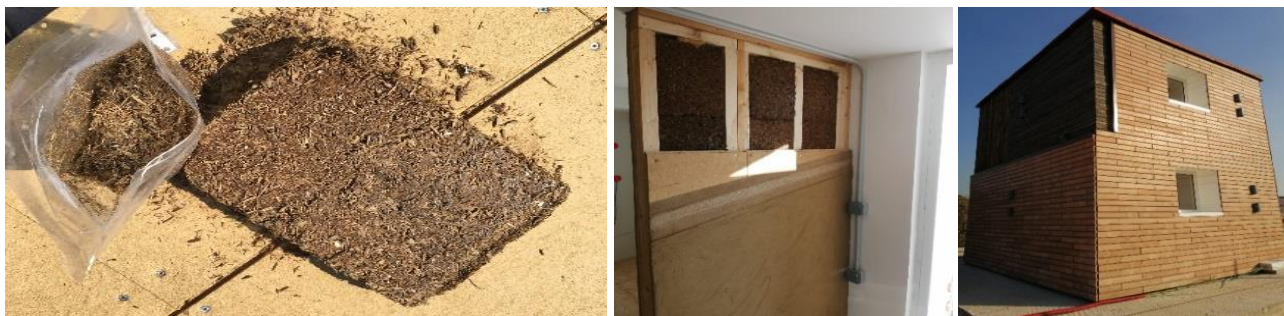
RE 4 : Validazione di pannelli isolanti a base di fibre di legno 100% riciclate e prive di leganti (sx) applicate in elementi divisorii interni (centro) nell'edificio dimostratore (dx) realizzato in Spagna presso il demo-park di ACCIONA
