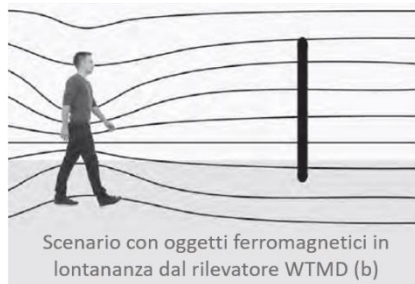
ITEL FMDS: Principio di funzionamento dei rilevatori FMDS (o anche WTMD – Walk-Through Metal Detectors)
