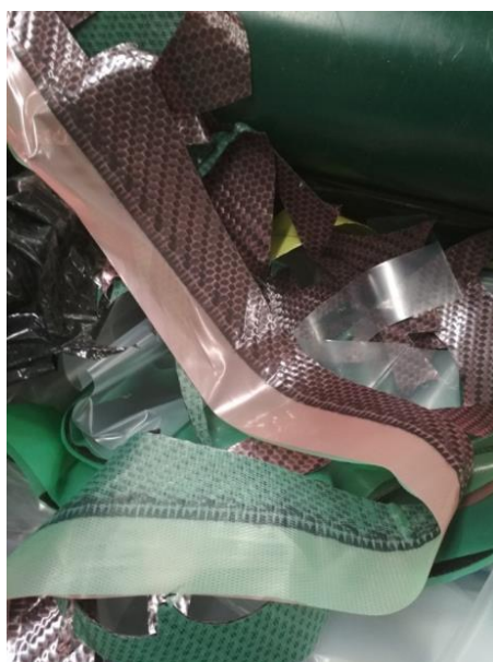
CIRCE ritagli e sfridi di lavorazione di tessuti pre-impregnati in fibra di carbonio per la produzione di puntali di calzature di sicurezza
